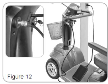
1. 충전기 출력부에 있는 충전기 커넥터에 배터리 충전기 코드를 삽입합니다. 정확한 위치에 대해 위 Figure 12를 참고하십시오.
